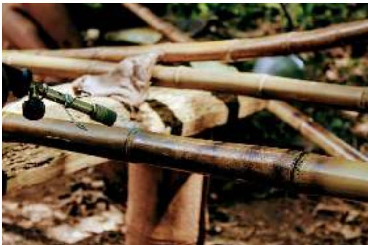
**Figura 1:** Tratamento de bambu utilizando maçarico
