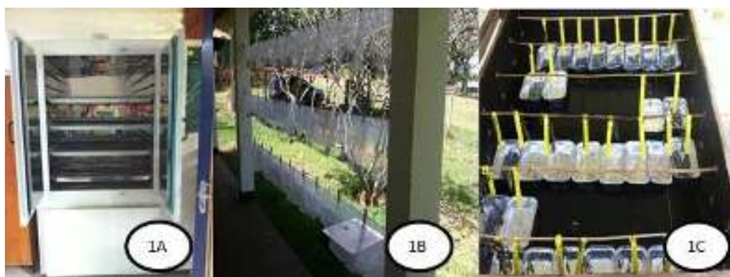
Figura 1: 1 A) Método de secagem na estufa; 1 B) Método de secagem no varal com saco de filó; 1C) Método de secagem na caixa
