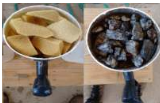
Figura 1 - Vista superior dos filtros tendo como Material suporte cubos de espuma de poliuretano e brita de construção civil.
