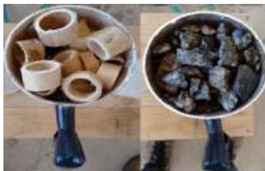
Figura 1 - Filtros tendo como Material suporte anéis de bambu e brita.
