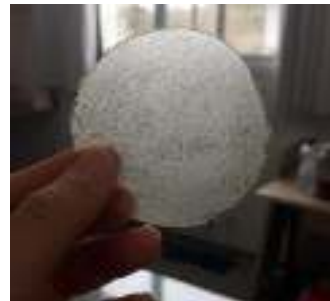
Figura 3. Carboximetilcelulose (CMC) produzido a partir do resíduo do milho. a) CMC sintetizada em forma de pó antes da polimerização. b) CMC polimerizado.
