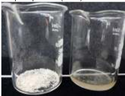
Figura 4. a) Teste de gelificação do CMC produzido em água. b) Testes em CMC comercial (b1) solução alcalina; em CMC sintetizado (b2) solução alcalina e em CMC sintetizado (b3) solução ácida.
