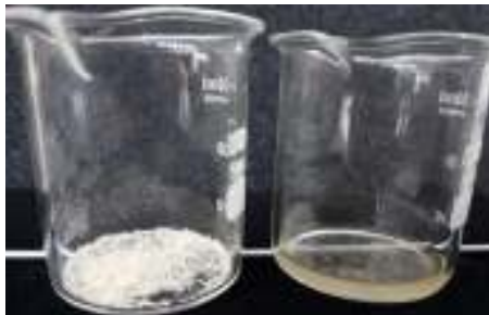
Figura 3. Carboximetilcelulose (CMC) produzido a partir do resíduo do milho. a) CMC sintetizada em forma de pó antes da polimerização. b) CMC polimerizado.
