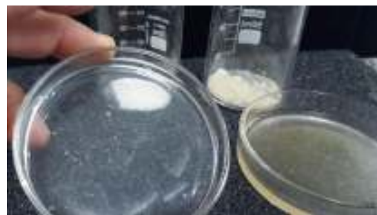
Figura 5. Preparação para obtenção do material polimérico. a) segurando a placa com CMC produzido. b) segurando a placa com CMC comercial.
