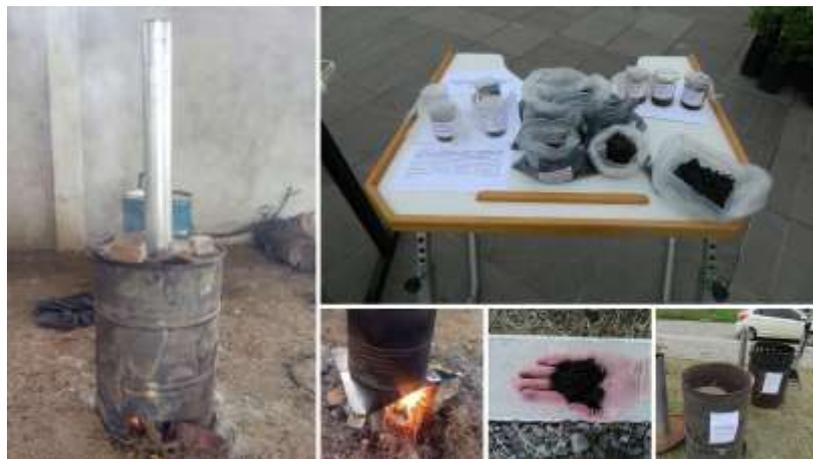
**Figura 4.** Reator artesanal utilizado para a produção de biocarvão a partir de engaço de uva e casca de arroz.
