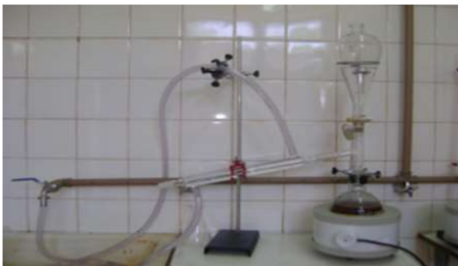
FIGURA 1. Aparelho convencional de destilador por arraste a vapor montado
