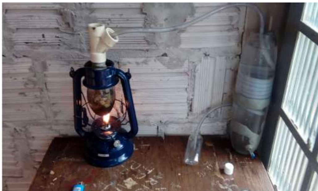
FIGURA 2. aparelho de destilador por arraste a vapor com material alternativo.
