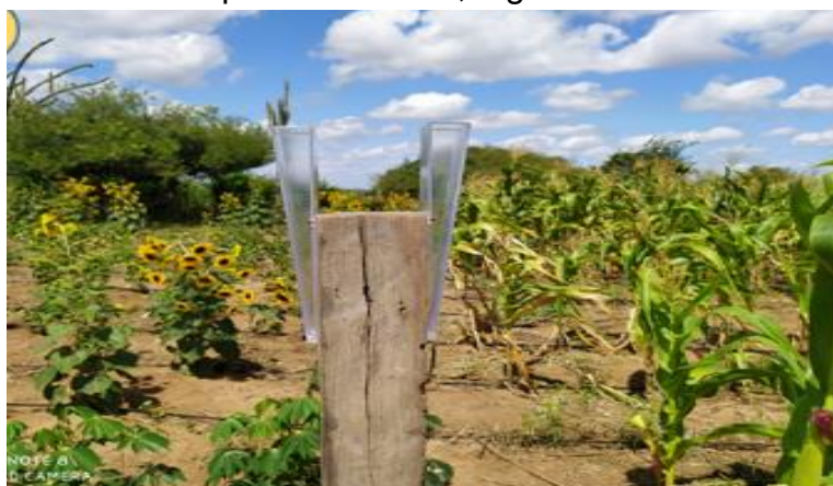
Figura 2. Modelo de pluviômetro instalado nos SAR's
