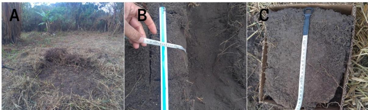
Figura 01. Abertura da minitrincheira (A), medição da amostra (B) e retirada do bloco de solo (C). Fonte: Própria
