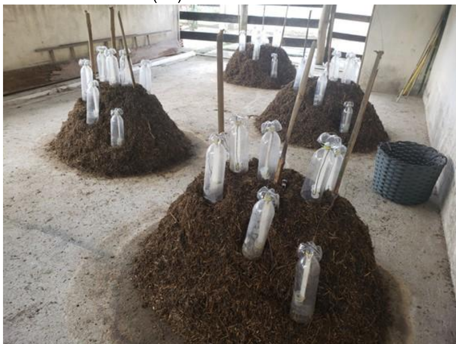
Figura 1- Disposição dos coletores SALES nas leiras de compostagem para quantificação da taxa de \text{NH}_3 volatilizado.
