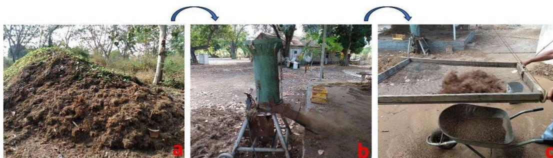
Figura 1: Processo de produção do pó de coco: a) material fibroso previamente processado; b) trituração do material e, c) peneiramento do material triturado para obtenção do pó de coco.
