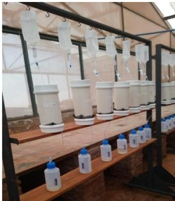
Figura 1. Estrutura do experimento com as colunas de lixiviação
