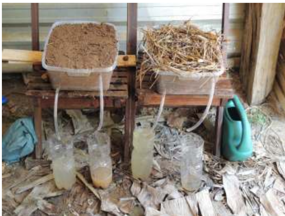
Figura 1: Simulador de erosão demonstrando as diferenças entre o solo coberto e descoberto em situações de chuva intensa e irrigação por aspersão.
